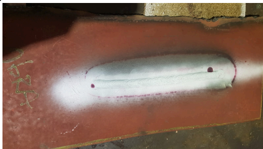
Figura 8 - Pontos de descontinuidade na amostra 2
