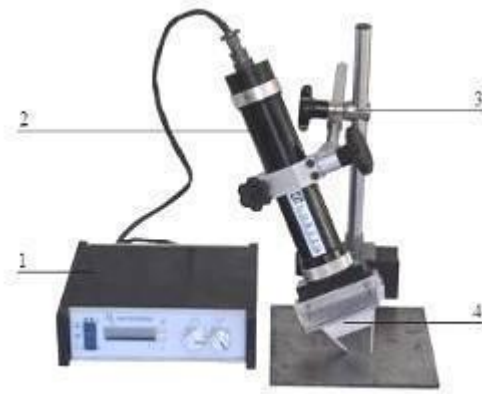
Figura 6 - Equipamento portátil de raios-X para medição de tensões mecânicas
