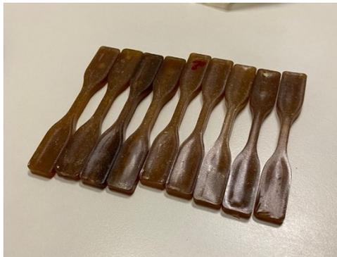
Figura 4. Corpos de prova produzidos.
