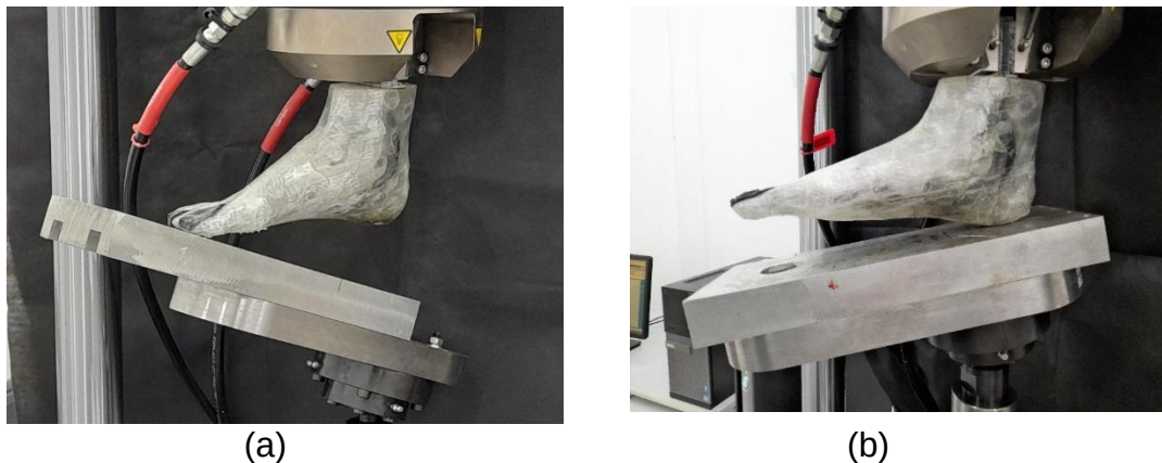
Figura 13 –Posição de ensaio frontal (a) e ensaio calcanhar (b). Fonte: Autor
