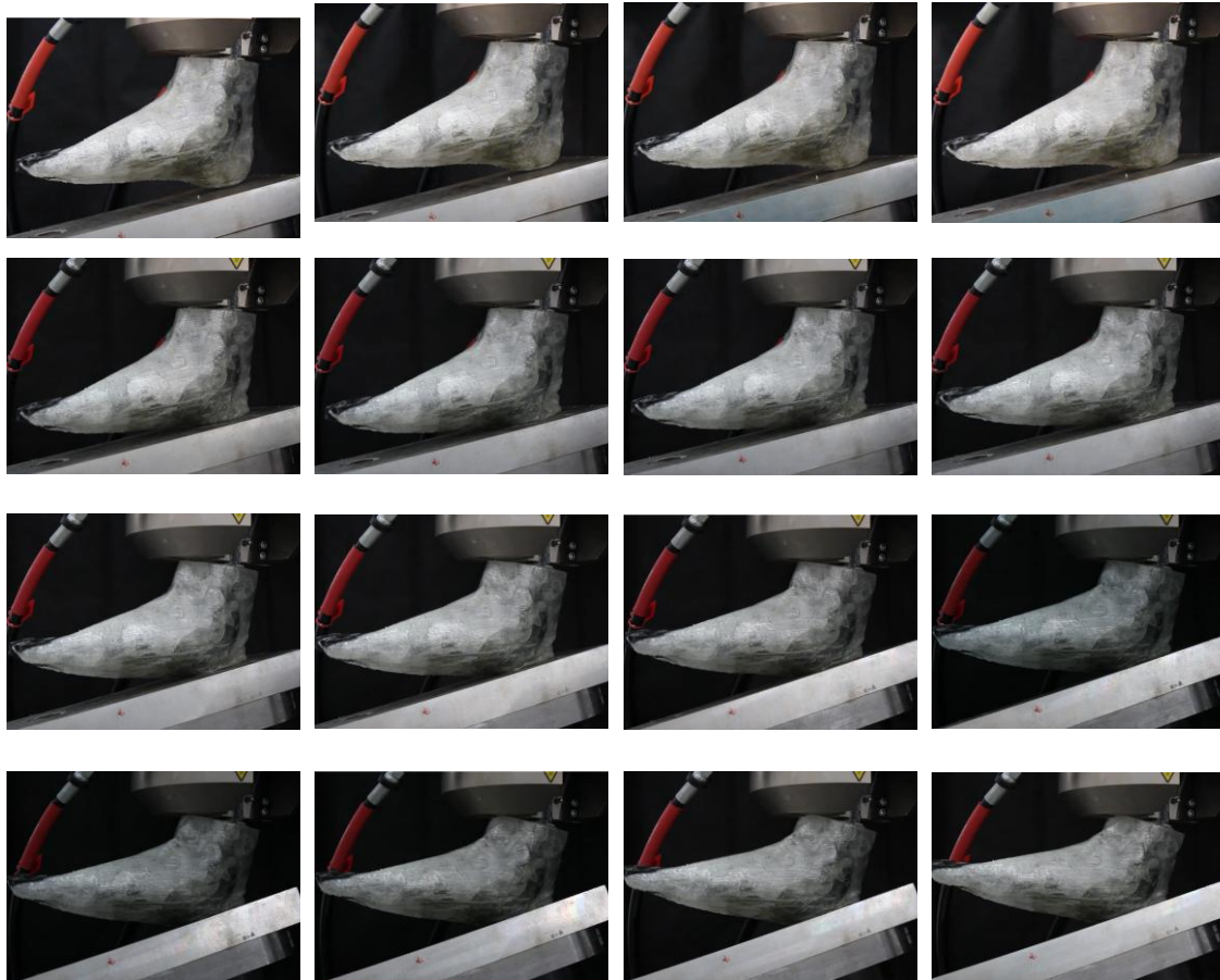
Figura 18 - Ensaio de Compressão no Calcanhar
