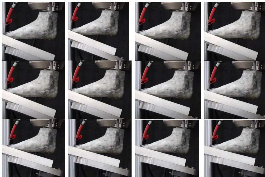
Figura 16 - Ensaio de Compressão no Antepé
