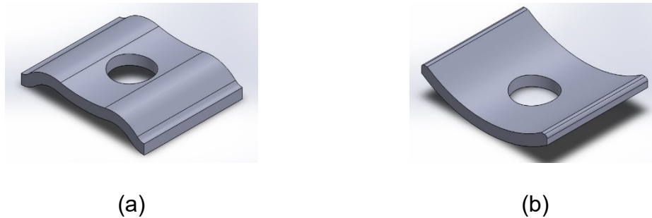
Figura 1 – Projeto da mola (a) tipo W e projeto da mola (b) tipo U.
