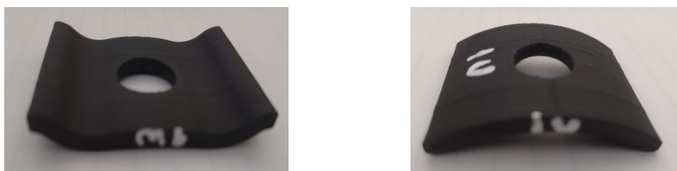
Figura 5 – Molas tipo W (a) e tipo U (b) após o processo de impressão 3D.
