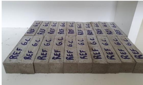
Fixou-se um traço de 1:3 (cimento:agregado) para a confecção das argamassas e uma relação água/cimento de 0,50, conforme NBR 16.738 (ABNT, 2019). Esta relação água/cimento foi definida através do ensaio de índice de consistência da amostra de referência A0, adicionando-se água até obter 260 mm de espalhamento, conforme NBR 13.276 (ABNT, 2016). Para todas as misturas, fixaram-se as seguintes quantidades de materiais: 936 g de cimento, 2.808 g de areia e 550 g de água.
