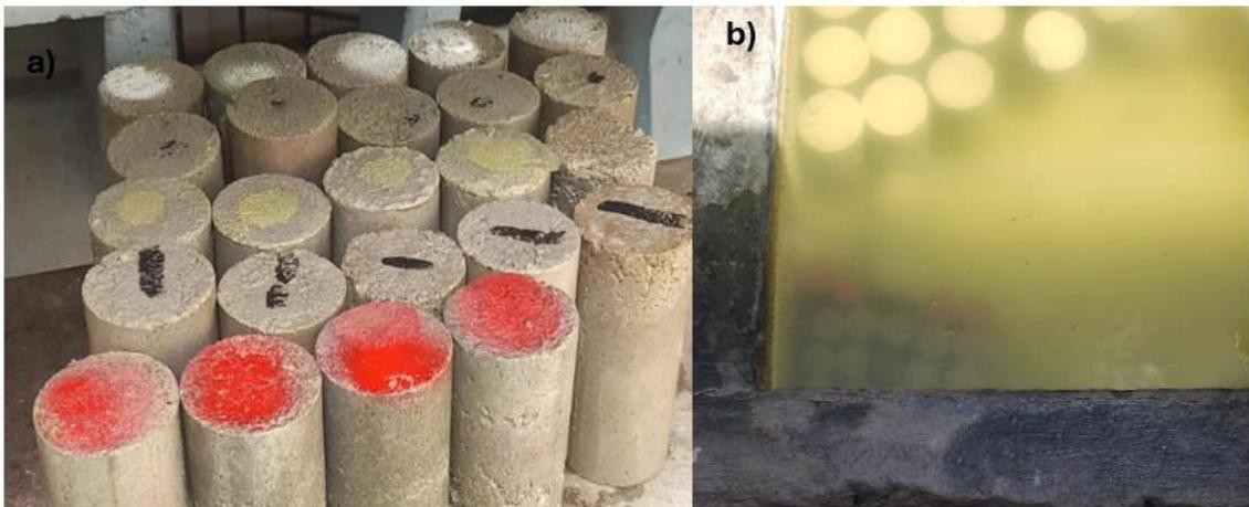
Os materiais foram misturados e moldados em corpos de prova cilíndricos com dimensões de 50mm x 100mm e então seguiram para a cura por 28 dias. Após este período, os corpos de prova foram submetidos a ensaios de compressão para avaliar a resistência mecânica. [15]
