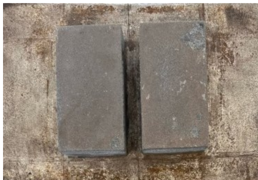
Figura 2. Amostras após compressão manual e desmoldagem
