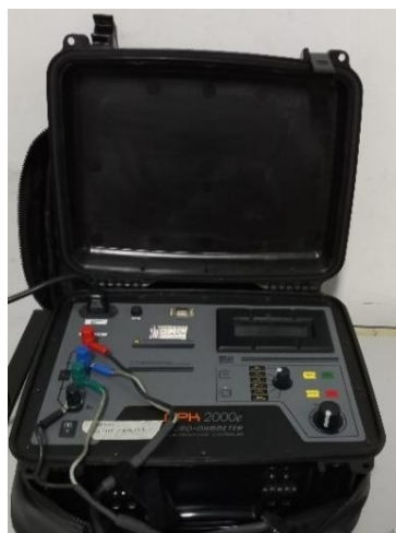
Figura 3 – Microhmímetro usado no ensaio.
