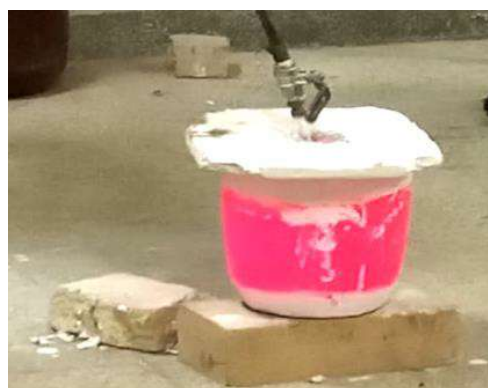
Figura 2. (A) Retirada do cadinho do forno para homogeneização do material; (B) Injeção do gás argônio.
