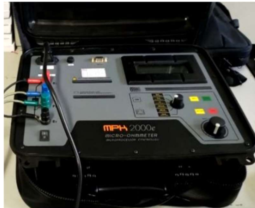
Figura 3. Microhmímetro usado no ensaio.
