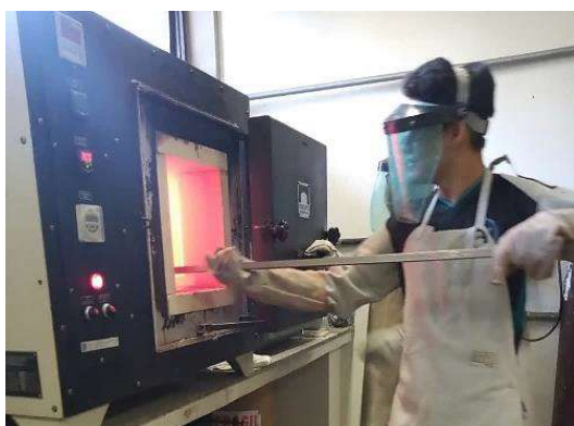
Figura 2. (A) Retirada do cadinho do forno para homogeneização do material; (B) Injeção do gás argônio.
