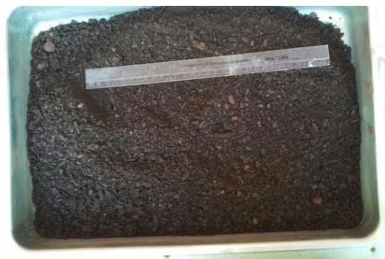
Após a micropelotização seguiram para um reator de leito fixo (Figura 5-a) para sinterização. O sinter final tem aspecto poroso conforme a Figura 5-b.
