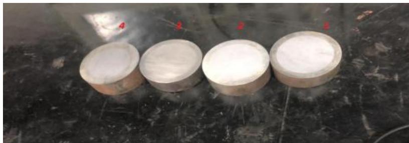
A Tabela 1 apresenta as medidas da espessura da camada temperada por indução, obtidas em trabalho anterior (3). As medidas foram obtidas com paquímetro e através de um perfil de microdureza realizado da borda até o centro
