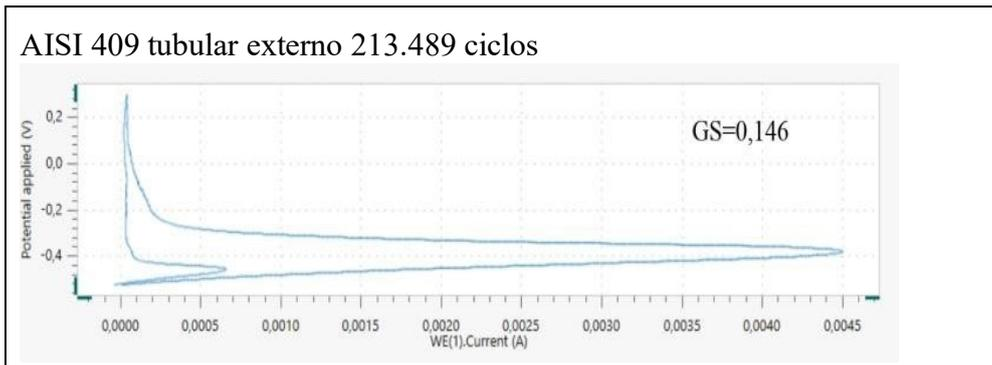
Figura 6. Curva de polarização das amostras AISI 409 arame tubular solda externa: a-) sem fadiga; b-) com fadiga.
