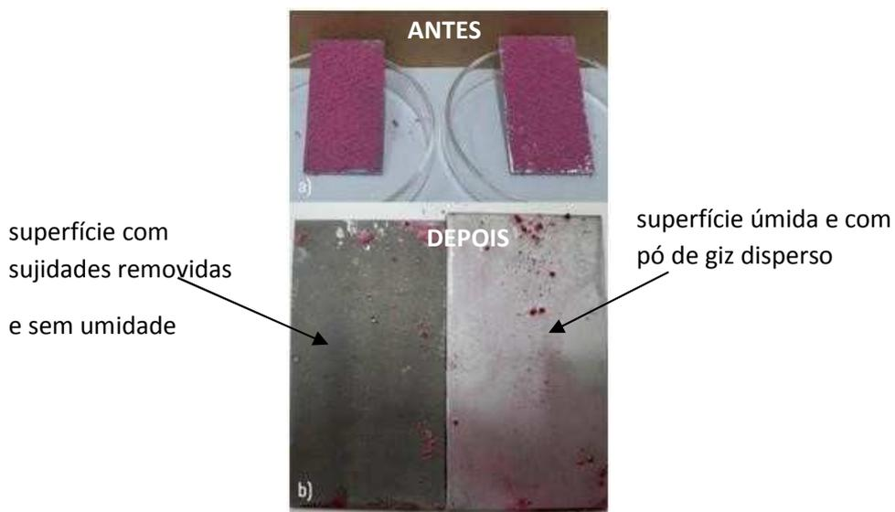
Os resultados mostraram que as ligas AA1100 e AA3105 tratadas demonstraram boas características de autolimpeza, removendo totalmente as sujidades (pó de giz) e mantendo a superfície isenta de umidade. Nas amostras sem tratamento a superfície permaneceu molhada e com resíduos de pó de giz.
