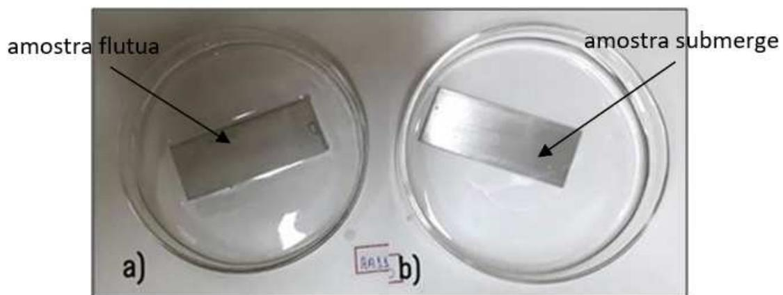
Figura 6 – Ensaio de flutuabilidade das amostras AA3105: (a) amostra tratada e (b) amostra sem tratamento.
