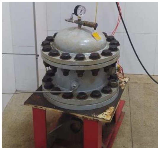
Figura 2: Autoclave para teste de corrosão sob tensão em operação.
