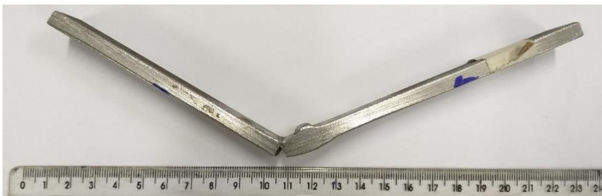
Figura 8: Aspecto morfológico da trinca da chapa com eletrodo maranging testado em fadiga.
