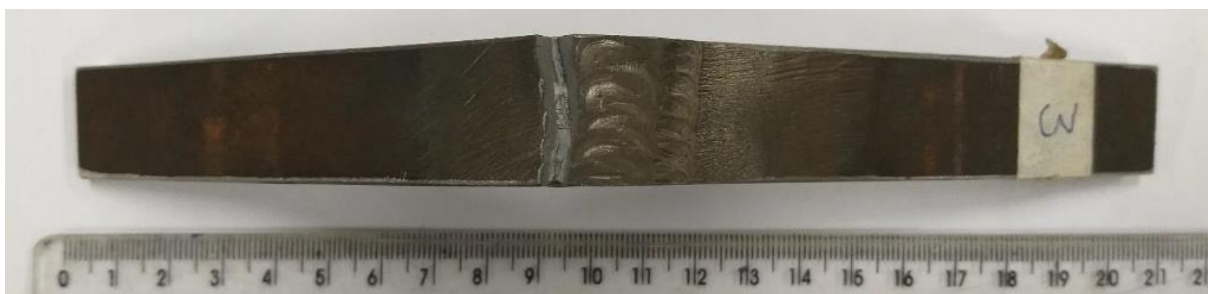
Figura 7: Aspecto morfológico da trinca da chapa com eletrodo maranging testado em fadiga.
