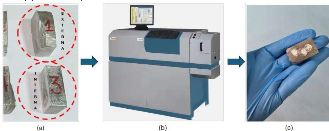
Figura 4. Determinação da composição química do material. (a) amostras e suas regiões de análise “externa” e “interna”; (b) representação do espectrofotômetro utilizado; (c) amostra após análise.
