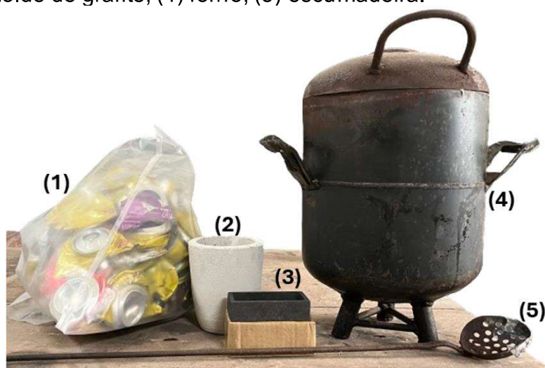
Figura 1. Materiais utilizados na fundição. (1) Latas prensadas; (2) cadinho para fundição; (3) molde de grafite; (4) forno; (5) escumadeira.
