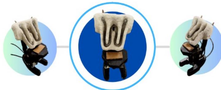
Figura 6. Exibição do dispositivo de molhabilidade desenvolvido em várias perspectivas.
