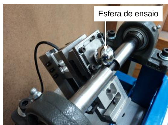
Figura 3. Equipamento de ensaio de desgaste micro-abrasivo por esfera rotativa de configuração mecânica “ esfera-livre ”, utilizado nos ensaios tribológicos deste trabalho.
