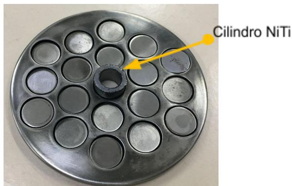
No interior do reator, a organização foi realizada conforme relatado por (8), onde o substrato de vidro foi posicionado sobre uma base de alumina, sendo este abrigado pela gaiola contendo os cilindros catódicos.
