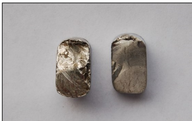
Figura 4 – Foto: macrografia das superfícies de fratura. Pode-se observar que a superfície do lado esquerdo da foto está amassada, não permitindo assim uma análise de sua fratura.
