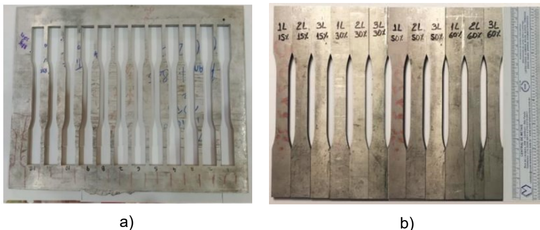
Figura 2 - Corpos de prova da liga AA3105 obtidos por eletroerosão a fio a) chapa e b) corpos de prova.
