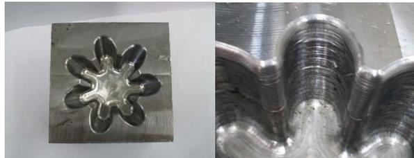
Em todos os testes houve o lascamento da ferramenta utilizada. Isso se deu devido à alta dureza do material e da complexidade da superfície usinada. Na tabela 2, mostra-se as dimensões do desgaste de flanco máximo dos inserts (medido na aresta principal de folga).
