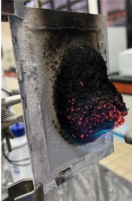
Figura 7. Tinta TGE no teste de resistência de fogo.
