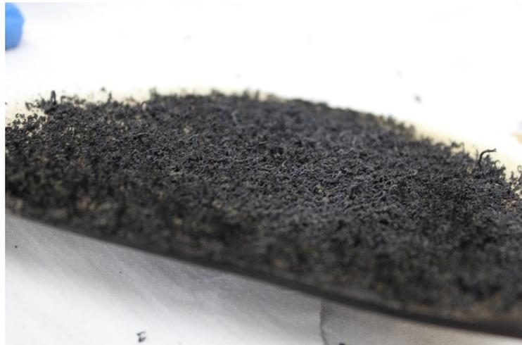
Figura 9. Tinta TGEDX após teste de queima.
