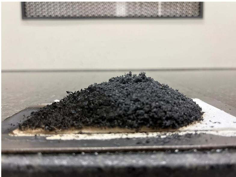
Figura 8. Tinta TGEML após teste de queima.
