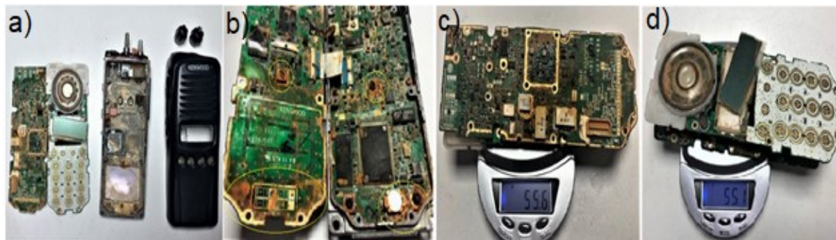
Figura 5: Rádio usado em ambiente minerador: (a) e (b) desmontado, (c) pesagem de uma PCI antes da limpeza e (d) pesagem da PCI após higienização e secagem.
