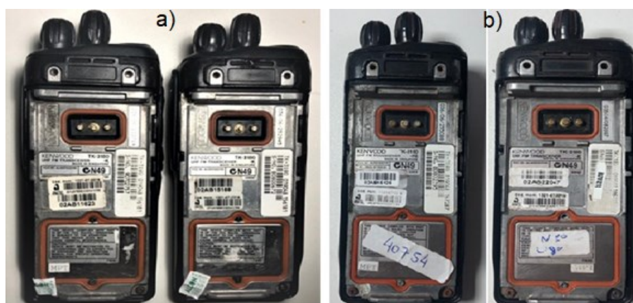
Figura 1: Exemplos de rádios de comunicação avaliados; (a) rádios em perfeito estado, (b) rádios inutilizados por eventos associados à corrosão.
