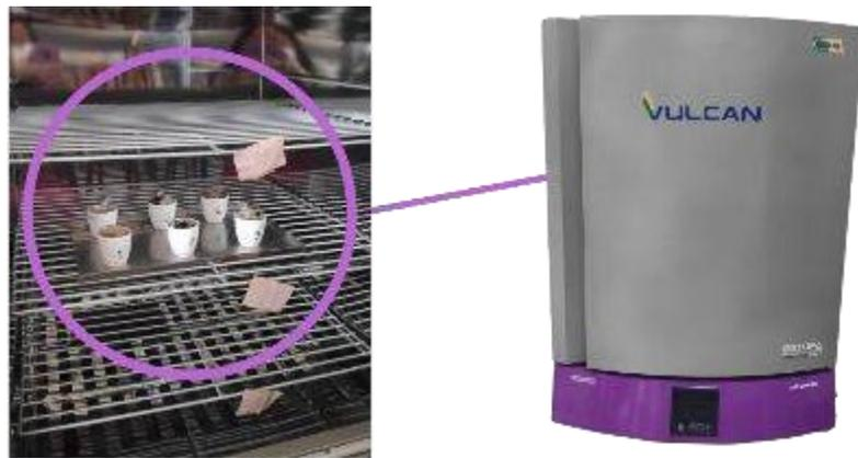
**Figura 3** - Amostras submetidas à secagem para determinação de umidade em estufa. **Fonte:** Autoria própria.
