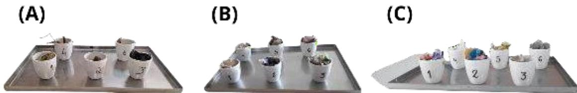
**Figura 2** - Amostras para determinação de umidade. (a)CDR-like; (b) Plástico Bruto; (c) Plástico Limpo. **Fonte:** Autoria própria.
