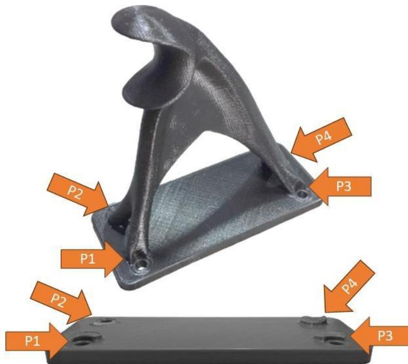
Figura 6. Modelo após ensaio, indicando os pontos de ruptura com alturas diferentes
